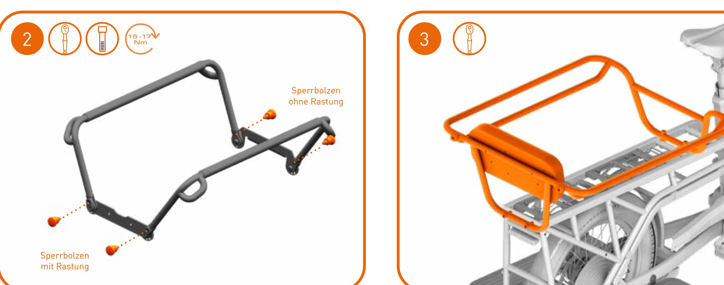
Befestigen Sie hinten die Sperrbolzen mit der Rastfunktion und vorne die Sperrbolzen ohne Rastfunktion.
