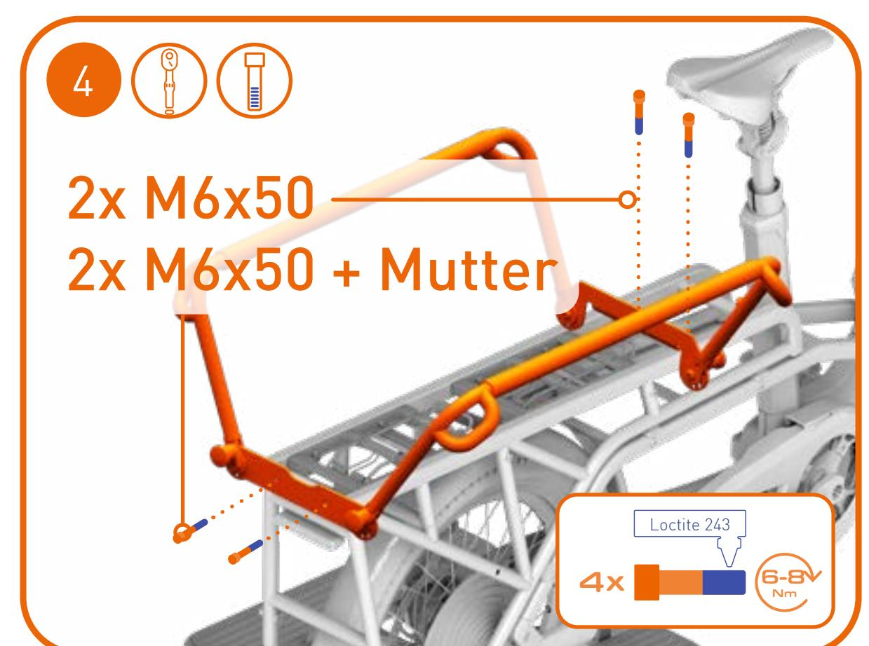
Positionieren Sie die Vario Bar und befestigen Sie diese.
