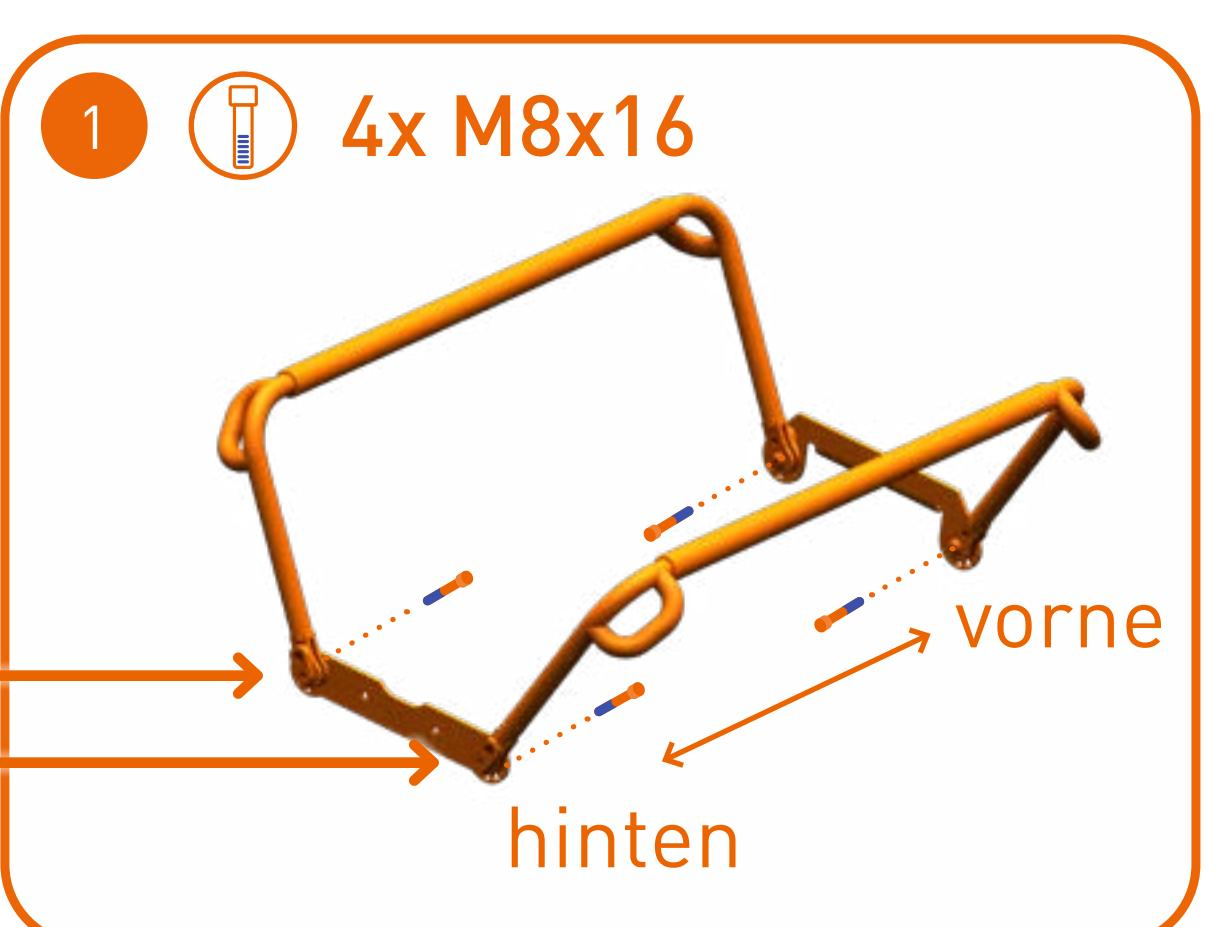
Befestigen Sie die Seitenbügel an die Montageblechen vorne und hinten an der zentrischen Bohrung. Ziehen Sie die Schrauben so fest, dass sich die Bügel einfach bewegen lassen.
