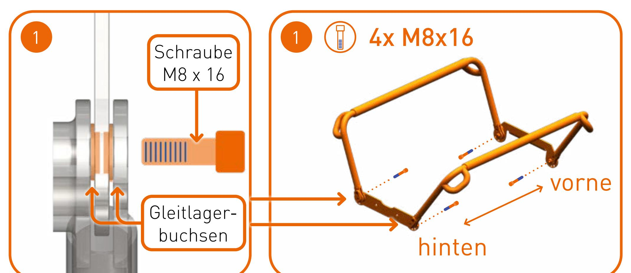
Platzieren Sie, wie dargestellt, die Gleitlagerbuchsen von beiden Seiten an den Enden der Seitenbügel.
